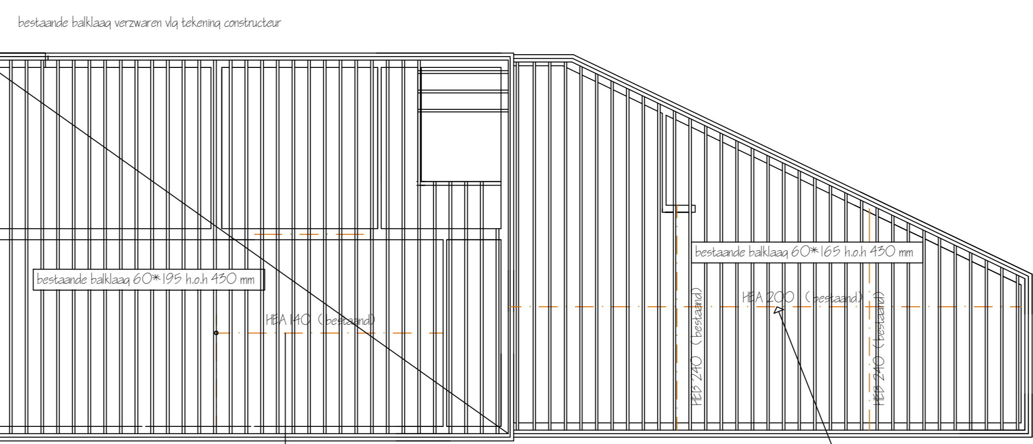
balklaag 1e verdieping
